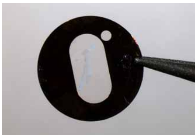
Фото 19. Ленты ультратонких срезов монтируют на опорных сеточках как на предметном стекле для светового микроскопа.
