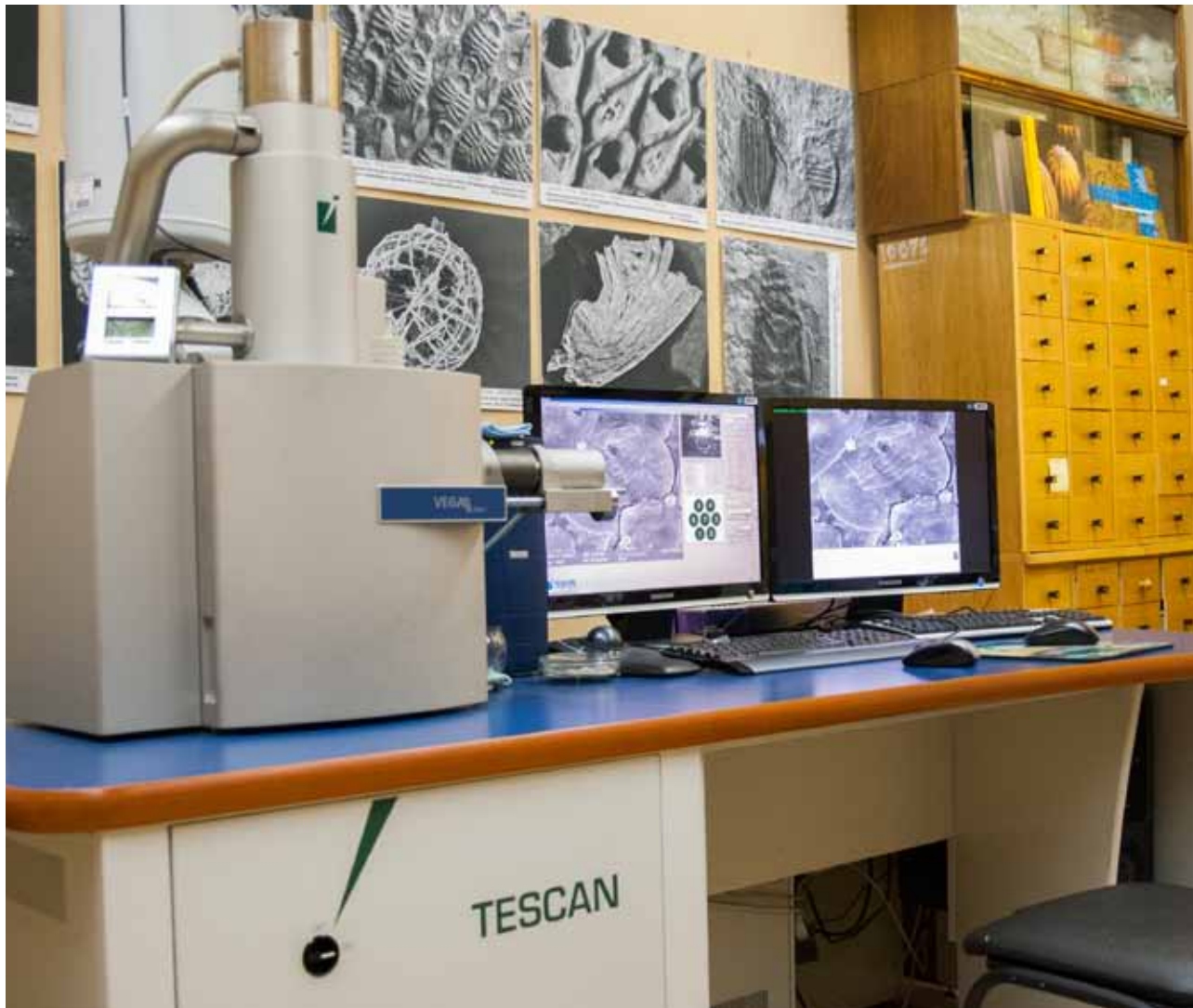
Фото 12. Сканирующий электронный микроскоп (СЭМ) – необходимый инструмент в любом исследовании поверхности клеточных стенок растений. Он состоит из колонны, где создается поток электронов, бомбардирующих объект исследования, и установлены детекторы, которые анализируют потоки электронов, проваимодействовавших с объектом исследования. Обработанный сигнал от детекторов передается на компьютер, который строит изображение. СЭМ позволяет подробно рассматривать элементы поверхности образцов нанометровых размеров. Однако предъявляет к образцу особые требования: для получения качественного изображения на больших увеличениях объект должен выдерживать помещение в вакуум и бомбардировку электронами, то есть быть сухим и электропроводным. Из всех объектов живой природы именно ископаемый материал в наибольшей степени удовлетворяет требованиям электронной микроскопии и позволяет получить информацию без потери свойств живого, которые он за миллионы лет залегания в породах потерял естественным образом. На фото – один из СЭМ Палеонтологического института. На мониторах видно изучаемое ископаемое полевое зерно.
