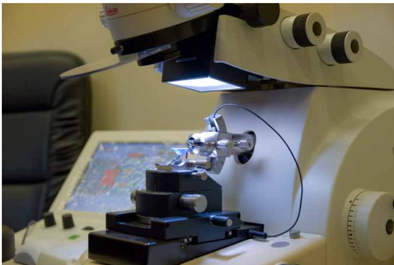
Фото 18. Ультратонкие срезы изготавливают на специальном приборе – ультрамикротоме, оснащенный алмазным или стеклянным ножом.
