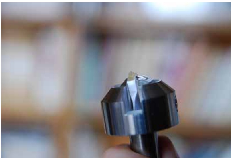
Фото 16. В держателе излишек смолы удаляют с тем, чтобы позднее нож ультрамикротомы резал не пустую смолу, а изучаемый объект.
