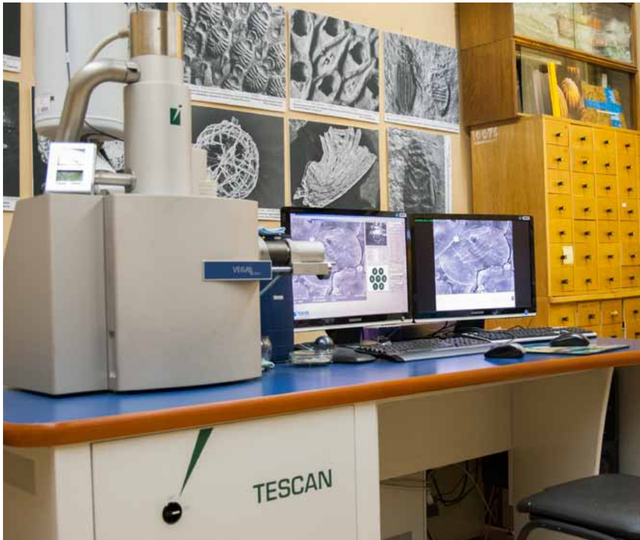
Фото 12. Сканирующий электронный микроскоп (СЭМ) – необходимый инструмент в любом исследовании поверхности клеточных стенок растений. Он состоит из колонны, где создается поток электронов, бомбардирующих объект исследования, и установлены детекторы, которые анализируют потоки электронов, провазимодействовавших с объектом исследования. Обработанный сигнал от детекторов передается на компьютер, который строит изображение. СЭМ позволяет подробно рассматривать элементы поверхности образцов нанометровых размеров. Однако предъявляет к образцу особые требования: для получения качественного изображения на больших увеличениях объект должен выдерживать помещение в вакуум и бомбардировку электронами, то есть быть сухим и электропроводным. Из всех объектов живой природы именно ископаемый материал в наибольшей степени удовлетворяет требованиям электронной микроскопии и позволяет получить информацию без потери свойств живого, которые он за миллионы лет залегания в породах потерял естественным образом. На фото – один из СЭМ Палеонтологического института. На мониторах видно изучаемое ископаемое полевое зерно.
