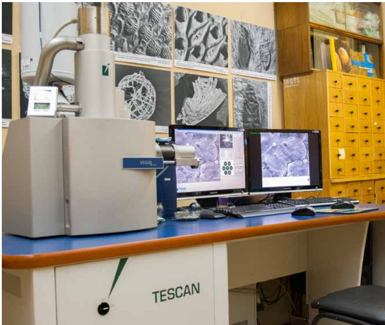
Фото 12. Сканирующий электронный микроскоп (СЭМ) – необходимый инструмент в любом исследовании поверхности клеточных стенок растений. Он состоит из колонны, где создается поток электронов, бомбардирующих объект исследования, и установлены детекторы, которые анализируют потоки электронов, провзаимодействовавших с объектом исследования. Обработанный сигнал от детекторов передается на компьютер, который строит изображение. СЭМ позволяет подробно рассматривать элементы поверхности образцов нанометровых размеров. Однако предъявляет к образцу особые требования: для получения качественного изображения на больших увеличениях объект должен выдерживать помещение в вакуум и бомбардировку электронами, то есть быть сухим и электропроводным. Из всех объектов живой природы именно ископаемый материал в наибольшей степени удовлетворяет требованиям электронной микроскопии и позволяет получить информацию без потери свойств живого, которые он за миллионы лет залегания в породах потерял естественным образом. На фото – один из СЭМ Палеонтологического института. На мониторах видно изучаемое ископаемое полевое зерно.
