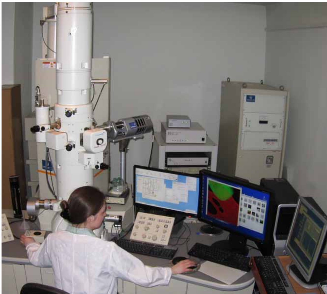
Фото 21. Работа на просвечивающем электронном микроскопе сопряжена с большими трудностями подготовки образца исследования. Поскольку в этом приборе анализируется поток электронов, прошедших сквозь образец, не повредив его, анализируемый образец должен быть очень тонким – ультратонким! Ультратонкие срезы образца помещают в специальную камеру в средней части колонны микроскопа и наблюдают тени от него, спроецированные на специальный экран в нижней части колонны. Современные трансмиссионные электронные микроскопы (ТЭМ) оснащены ССD-камерами, которые оцифровывают изображение и выводят его на экран монитора. ТЭМ позволяют биологам работать на максимальных для биологических объектов увеличениях – от нескольких клеток до отдельных макромолекул. Можно наблюдать и атомные решетки, но это уже не есть задача биолога.
